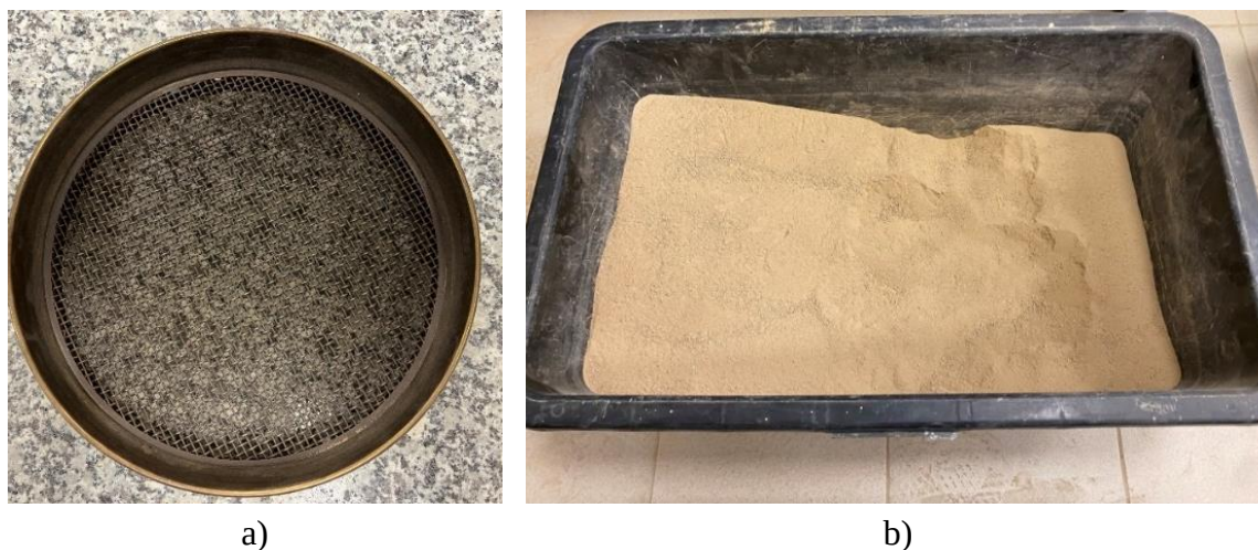
Rys. 4.3 a) Sito o oczkach 2,0 mm; b) Grunt nr 1 przygotowany do badań.
