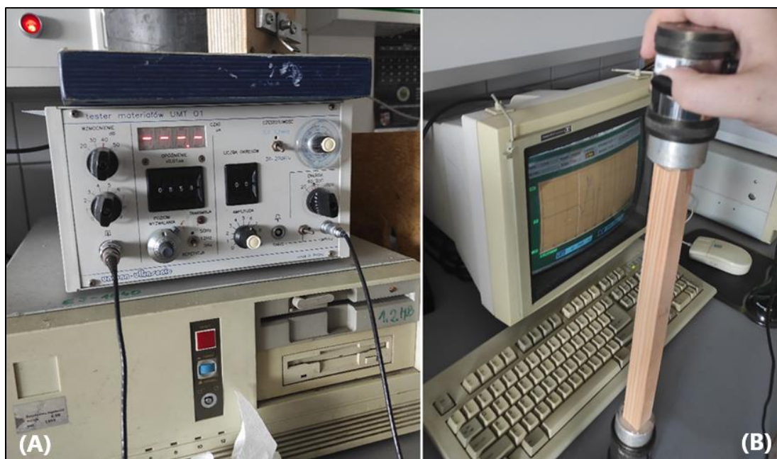
Ryc. 23. Tester materiałów UMT 01 (A) oraz pomiar czasu przepływu ultradźwięków przez DG (B)
