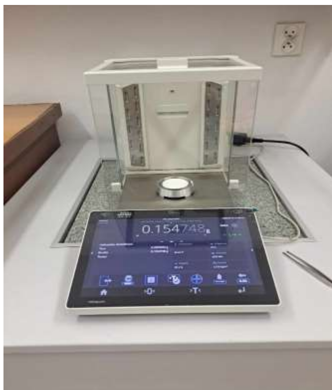
Rysunek 18. Mikrowaga analityczna firmy RADWAG
