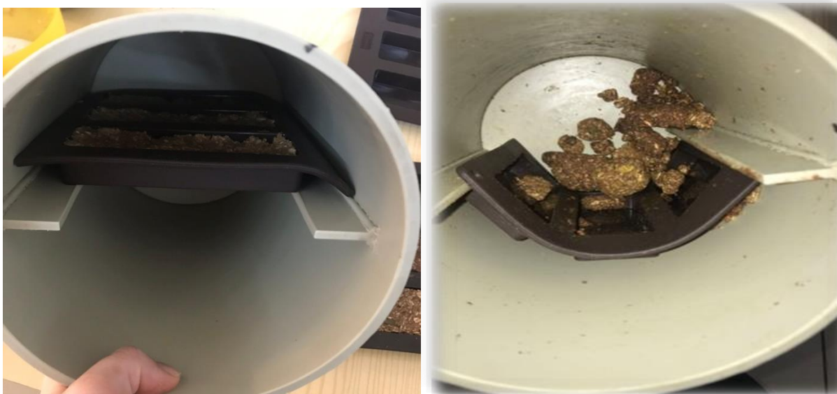
Rysunek 13. Próby otrzymania batonów metodą suszenia mikrofalowo-próżniowego, zdjęcie próbek z foremką silikonową w komorze suszarki (Rys. 45/Aneks)
