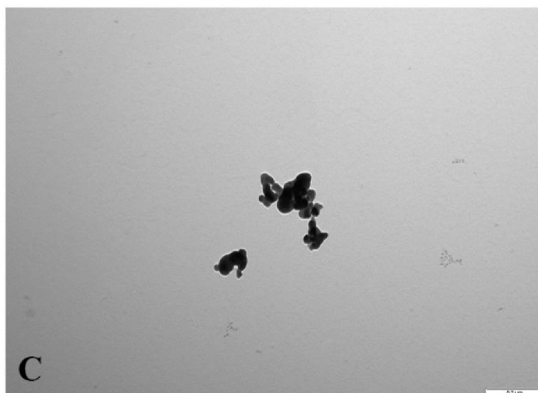
Rycina 2. Parametry i kształt nanocząstek srebra użytych w eksperymencie: (A) rozkład wielkości, (B) rozkład potencjału zeta (mV) oraz (C) morfologia agregatów nanocząstek srebra. Pasek skali: 0,2 \mu\text{m} (Szudrowicz i wsp., 2022).
