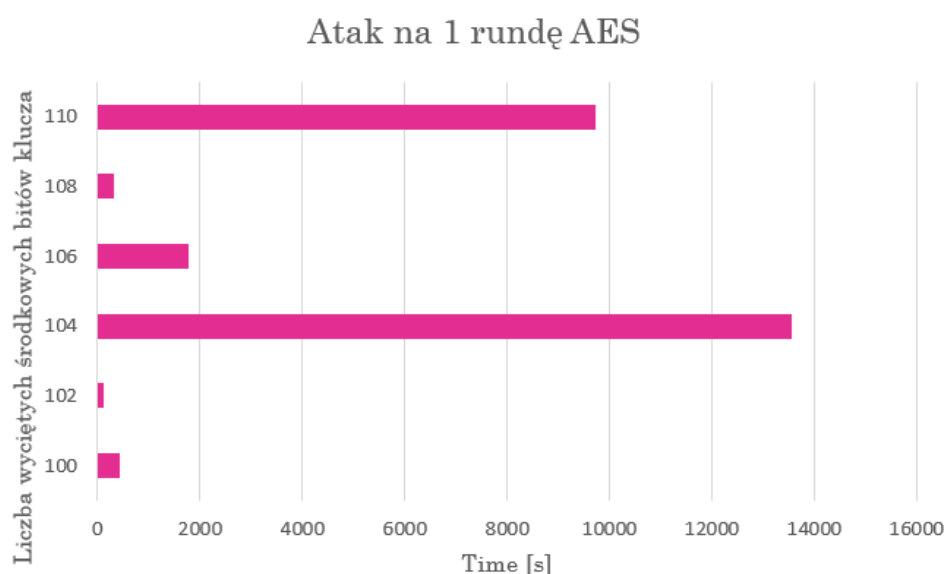
Rysunek 5.13: Atak na 1 rundę AES z dodanymi bitami klucza
