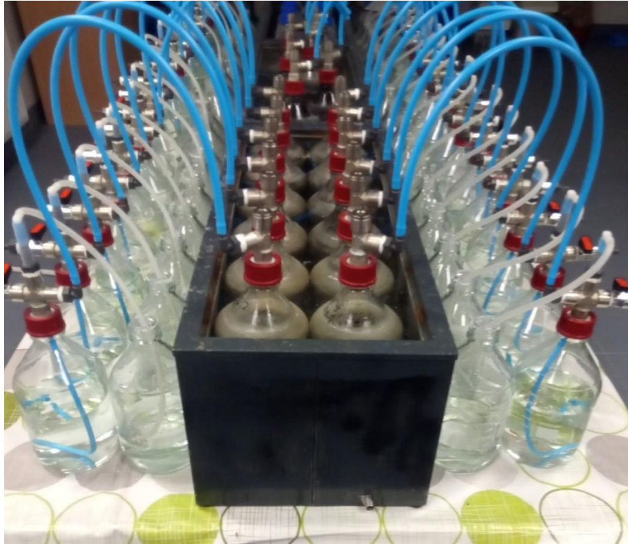
Rys. 1. Stanowisko do badań procesu fermentacji zgodne z VDI 4630
