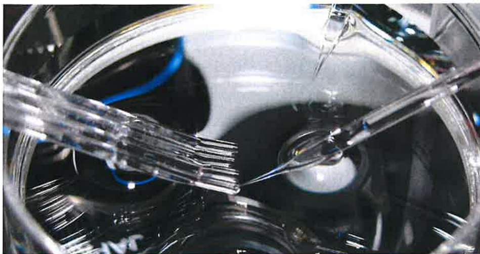
Rysunek 15. Pipeta pomiarowa (po prawej) oraz system perfuzji (po lewej cztery szklane kapilary) wykorzystywany w doświadczeniach patch-clamp.
