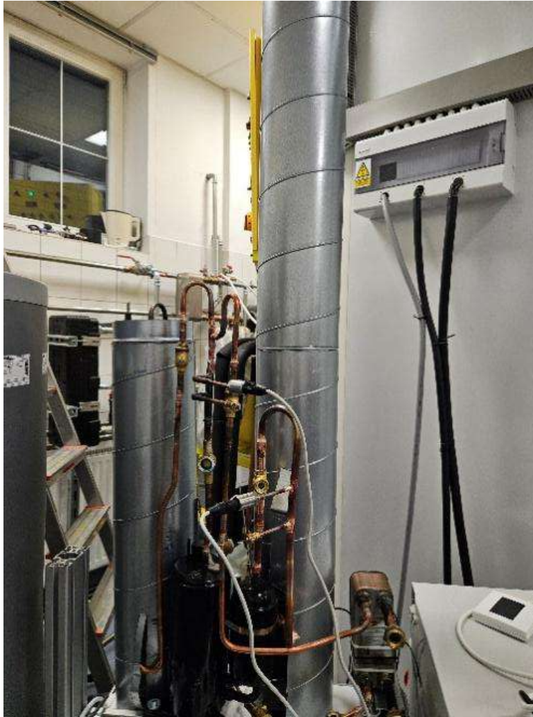
Rys. 11.12. Badania eksploatacyjne hybrydowego urządzenia grzewczego
