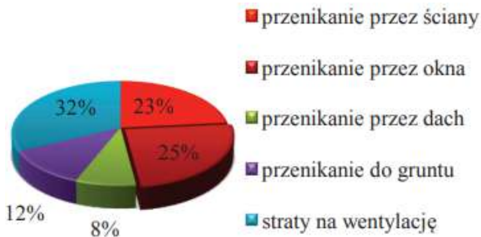
Rys. 5.6. Procentowy rozkład strat ciepła dla badanego budynku [214]
