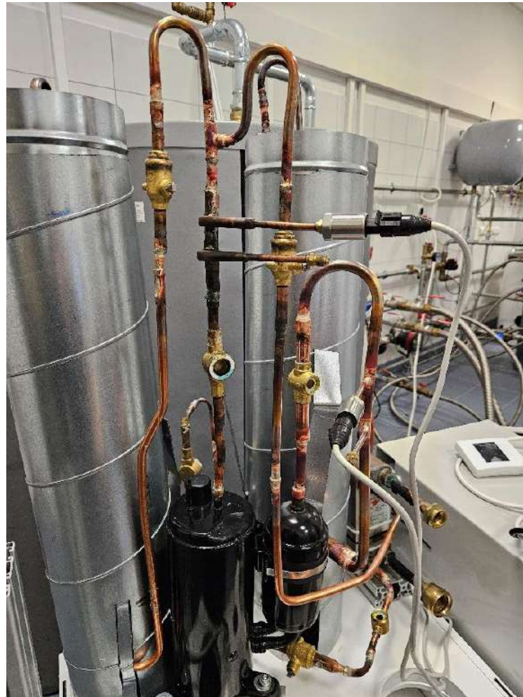
Rys. 11.10. Prototypowa instalacja hybrydowej pompy ciepła
