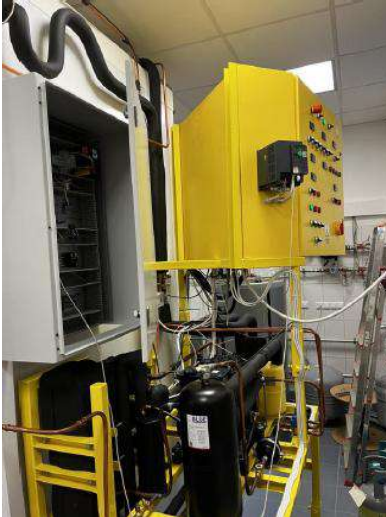
Rys. 11.4. Manualny panel sterowania i układ chłodniczy dwustrefowej komory chłodniczej
