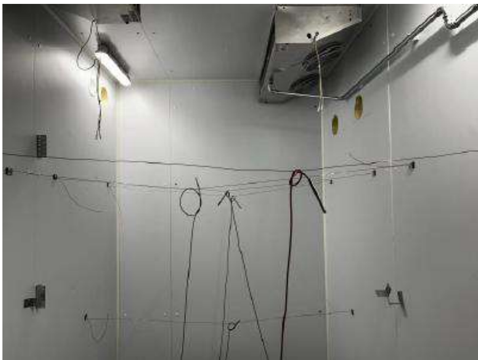
Rys. 11.2. Czujniki temperatury Pt1000 we wnętrzu dwustrefowej komory chłodniczej
