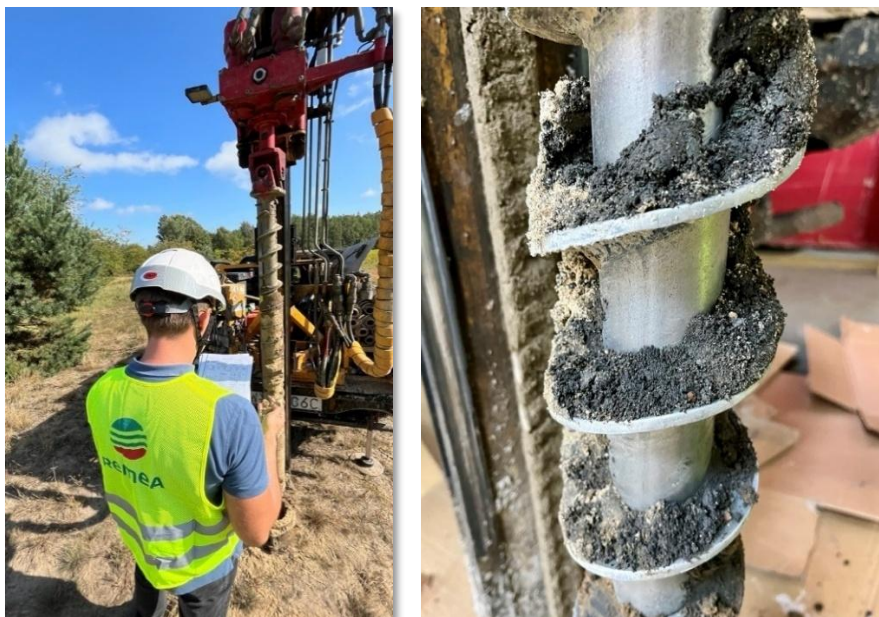
Rys. 5.4. Pobieranie próbek do badań przy wierceniu świdrem spiralnym.
