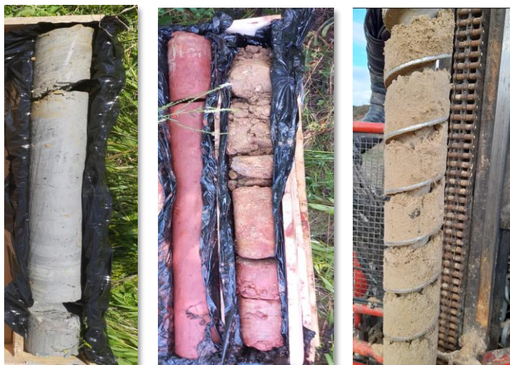
Rys. 5.14. Rodzaje próbek gruntu pobranych różnymi technikami.
