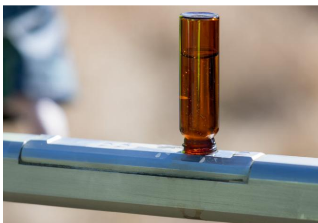
Rys. 5.11. Kalibracja sondy przed wykonaniem sondowania MIP (Remea Sp. z o.o.).
