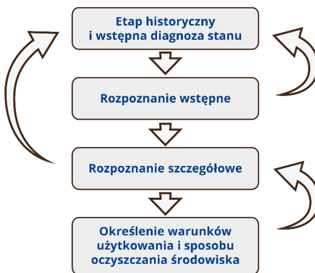
Rys. 5.1. Schemat strategii badań środowiska gruntowo-wodnego na terenach potencjalnie zanieczyszczonych (Irmiński, 1996).
