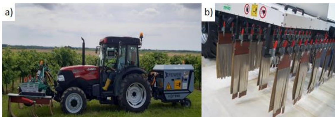
Rysunek 22. Urządzenie XPOWER. a – agregacja z ciągnikiem b – aplikator wysokiego napięcia. Źródło: [70], materiały własne.
