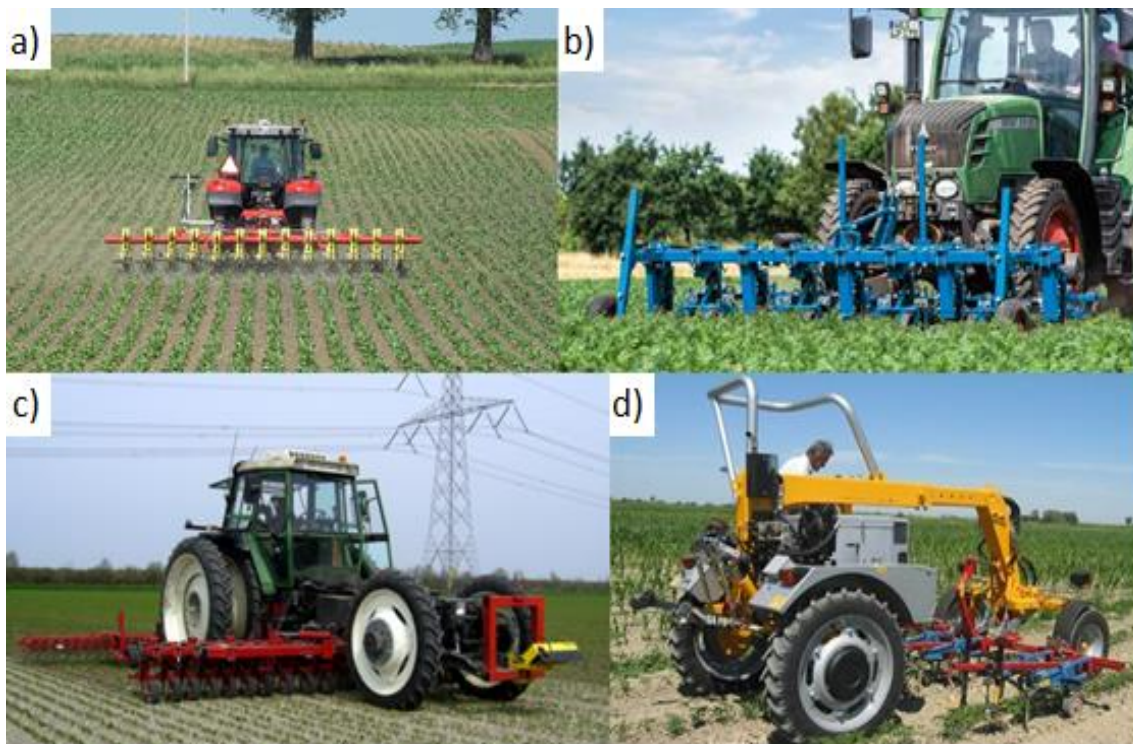
Rysunek 2. Systemy zawieszenia pielników na ciągniku: a – z tyłu, b – z przodu, c – pomiędzy kołami specjalnych ciągników, d – na nośniku narzędzi Źródło: [2-4].
