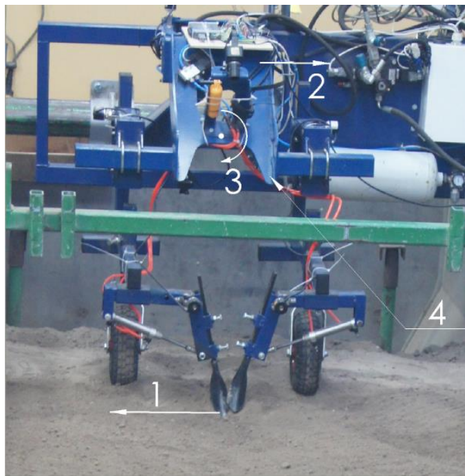
Rysunek 100. Naprężenie skrętne działające na sekcję podczas przesuwu poprzecznego. 1 – siła reakcji oporu gleby podczas przesuwu poprzecznego, 2 – siła przesuwu poprzecznego, 3 – moment skręcający wynikający z sił działających na konstrukcję, 4 – wspornika zawieszania części roboczych lewej i prawej podatny na skręcanie. Źródło: Opracowanie własne.
