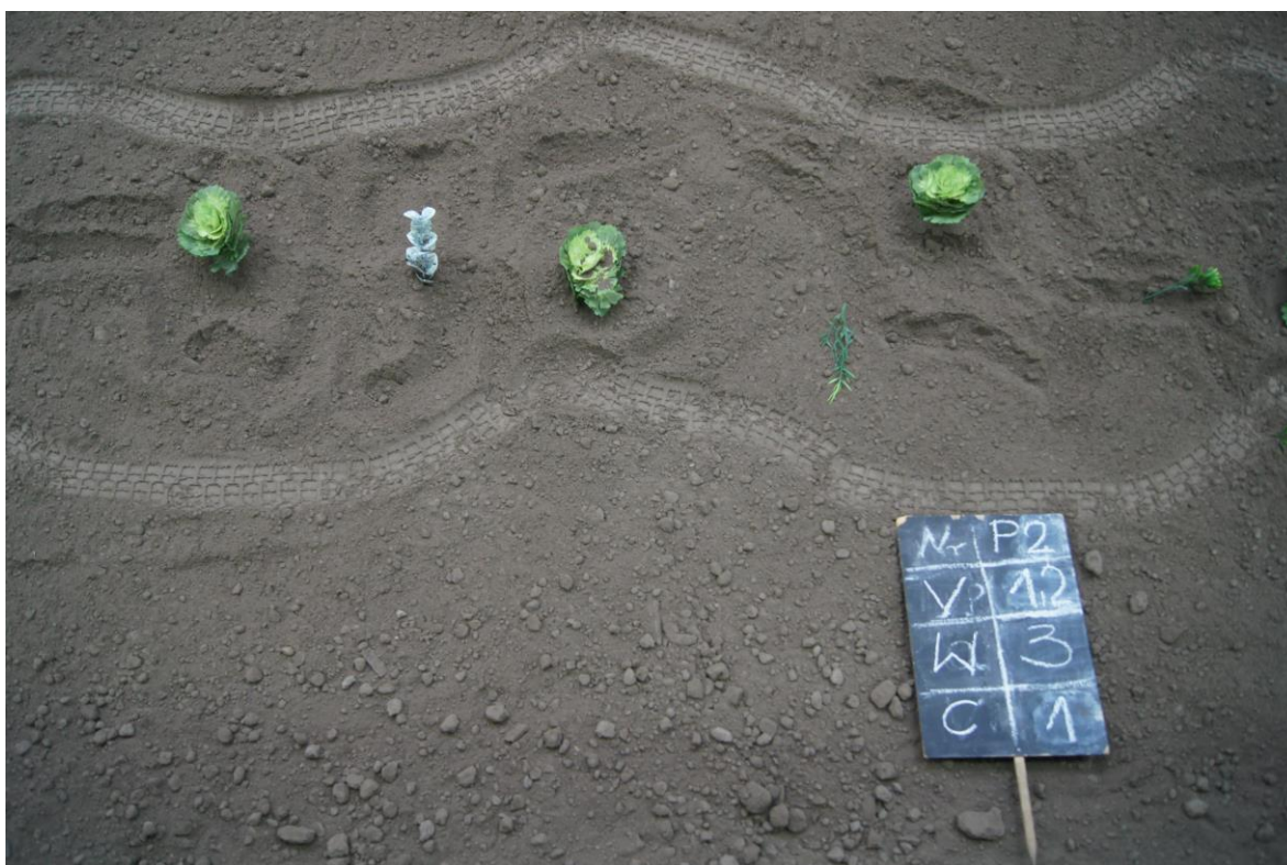
Rysunek 98. Przejazd W3V12C1P2 (wariant 3, prędkość 1,2 km/h, obecność chwastów, powtórzenie 2), zdjęcie powierzchni gleby po wykonanym przejeździe. Źródło: Opracowanie własne.
