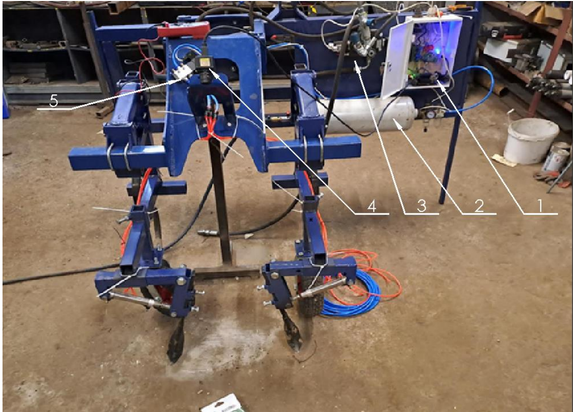
Rysunek 64. Prace przy etapie 3 budowy sekcji roboczej. 1 – szafa sterownicza, 2 – zbiornik powietrza instalacji pneumatycznej, 3 – elektrozawór hydrauliczny, 4 – kamera, 5 – elektrozawór pneumatyczny.
