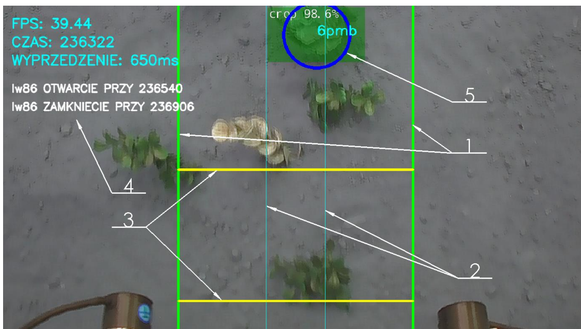
Rysunek 74. Widok z perspektywy kamery programu sterującego. 1 – linie zakresu sterowania poprzecznego, 2– linie histerezy ustawienia centralnego roślin, 3 – linie bramki wywoływania ruchu noży dłutowych, 4 – dane informacyjne, 5 – roślina z unikalnym identyfikatorem. Źródło: Opracowanie własne.
