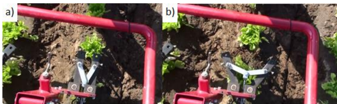
Rysunek 18. Nożycowy element roboczy. a – faza pracy pomiędzy roślinami w rzędzie, b – ominięcie rośliny. Źródło: [56].
