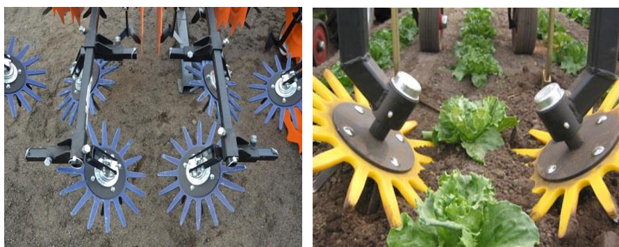
Rysunek 9. Gwiazdy palcowe doprawiające glebę w rzędzie roślin. Źródło: [5,20].
